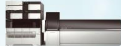
Hệ thống sắc ký lỏng ghép nối với khí phổ kép (LCMSMS/Tandem Mass) dùng cho sàng lọc rối loạn chuyển hóa bẩm sinh
