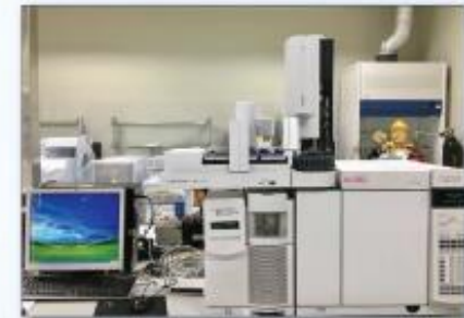
Hệ thống sắc ký khí phổ khối (GC/MS) phân tích axit hữu cơ
